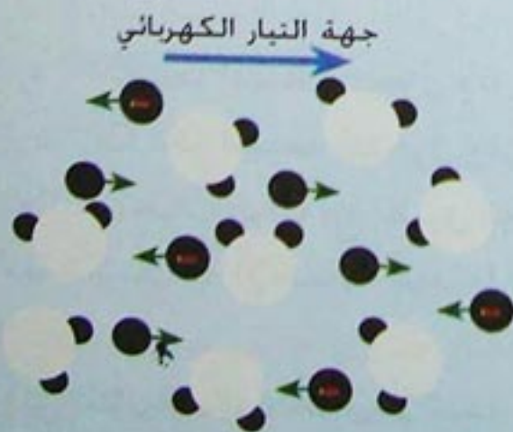
نموذج التيار الكهربائي في محلول شاردي
