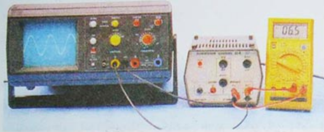
وثيقة 8: تركيب الدارة الكهربائية
